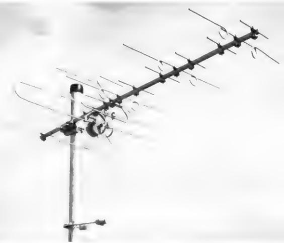
Billige 15-Element-UHF-Antenne von Roka. Diese Breitbandantenne für die Kanäle 21...37 (neue Zählweise) hat im Durchschnitt einen Gewinn von 11 dB, Vertikalbündelung: 40°, V/R-Verhältnis: 23 dB
