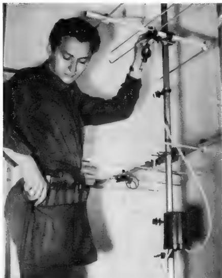
Bild 2. Die Werkzeug-Umhängetasche für den Antennenbauer (Bernstein KG, Remscheid-Lennep)
