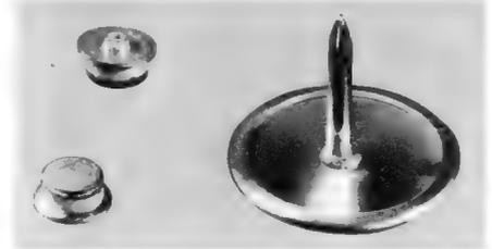
Bild 3. Die Koaxialdiode AE 101 im Größenvergleich zu einem Reißnagel
